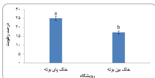
شکل ۱۴- مقایسه درصد رطوبت اشاع خاک بین خاک پای بوته و خاک بین بوته در منطقه پخش سیلاب
